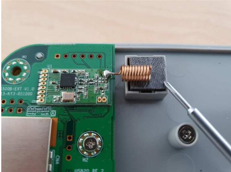
Man muss jetzt die Antenne vorsichtig etwas anheben, da sie mit dem Gummikissen leicht verklebt ist und kann sie jetzt mit Hilfe einer Pinzette oder einer spitzen Zange vorsichtig in die Länge ziehen.
