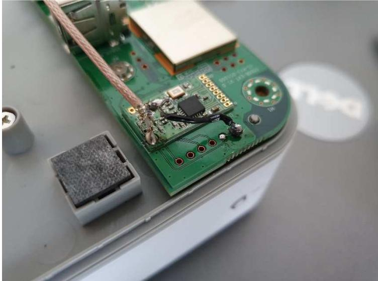
Der freiliegende, nicht abgeschirmte Teil des Pigtails sollte so kurz wie irgend möglich sein, da er bereits als Antenne wirkt. Auch das Stück Litze, mit dem die Abschirmung auf Masse gelegt wird, sollte so kurz wie möglich sein.
