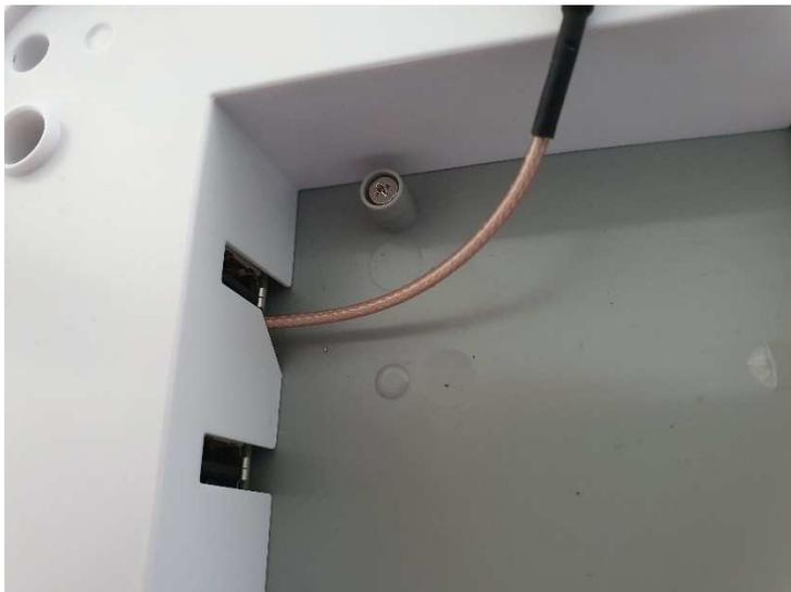
Um das Kabel in den Anschlussraum für USB-Dongles zu führen, kann man (z.B. mit Hilfe eines Seitenschneiders) eine Aussparung in das Gehäuse schneiden.
