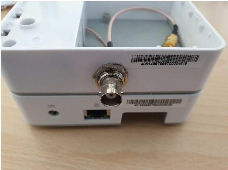
Die Antenne sollte mindestens 80 cm entfernt von der Zentrale aufgestellt werden, so dass sie sich nicht im Nahfeld der Prozessorplatine befindet, die selbst durch ihre hohe Taktfrequenz ein Störfeld um sich herum erzeugt.
